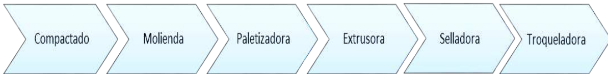
Figura 1. Flujo del proceso Fuente: Elaboración propia
